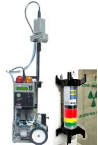
Balises de surveillance de la contamination et de l'irradiation
